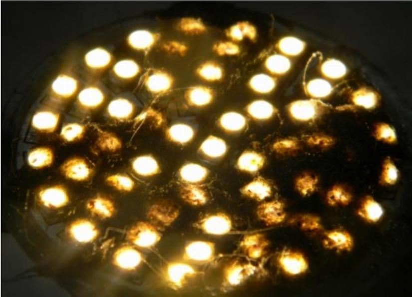
Thermische Überhitzung durch erhöhte Schmutzbelastung [Fas19a]
